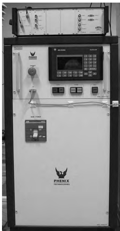
Rys. 16. Panel sterujący transformatora Phenix i system Doble Lemke z 2012 r. do pomiaru wyładowań niezupełnych
