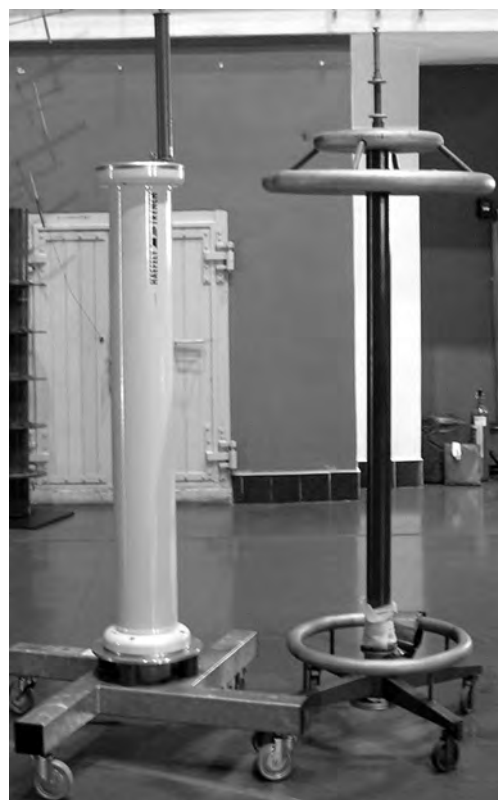
Rys. 12. Dzielnik uniwersalny Haefely RCZ 500, 500 kV udar/180 kV AC/DC z 1995. Dzielnik rezystancyjny TUR z 1977 r. do pomiaru napięć udarowych 700 kV, R=10 \text{ k}\Omega
