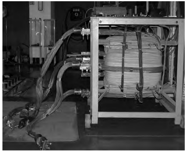
Rys. 11. Transformator wielkopoprądowy, ZWAR Warszawa, 1975 r., U_2 = 7,5 \text{ V} , I_2 = 7 \text{ kA} do prób kriokabli
