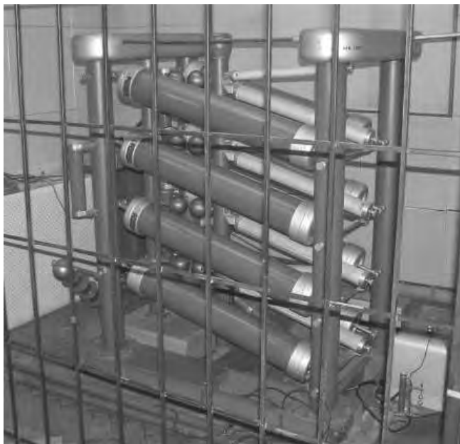
Rys. 9. Udarowy generator Marxa 500 kV, 2,2 kW, produkcji TUR Dresden
