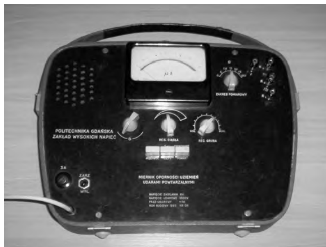
Rys 2. Widok miernika udarowego wykonanego w Politechnice Gdańskiej; przewód po lewej stronie służył do połączenia z akumulatorem
