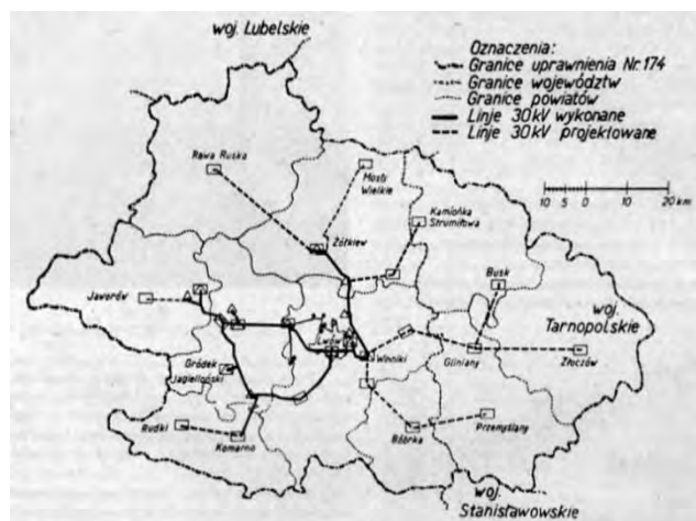
Fot. 10. Plan sieci 30 kV ZEOL z 1937 r. (źródło: „Przegląd Elektrotechniczny” 1937, nr 5, s. 358)
